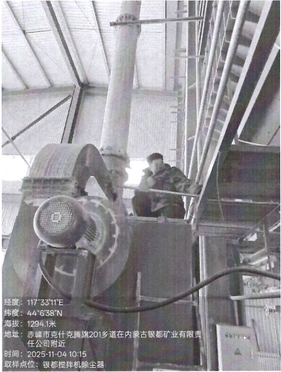
搅拌机除尘器排气筒监测口
